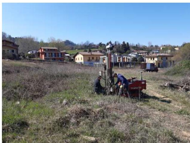
**Prova penetrometrica statica CPT3**
