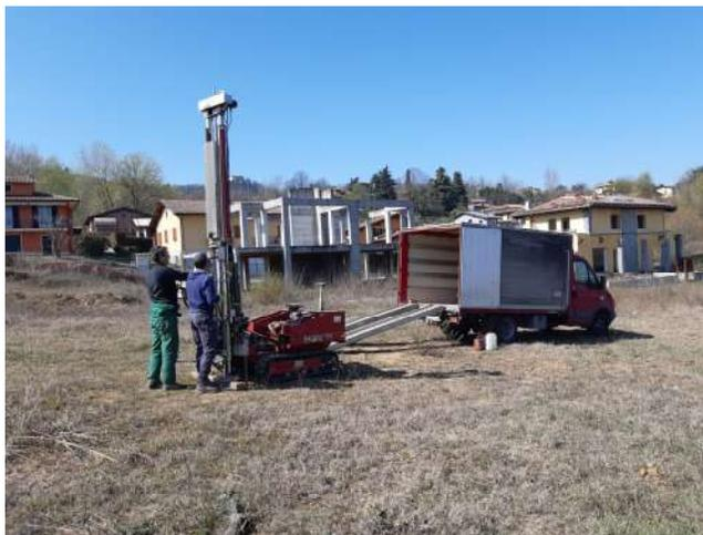
**Prova penetrometrica statica CPT1**
